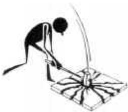
Un métal fragile est un métal qui se rompt au lieu de se déformer. Le verre, la fonte, le béton et les céramiques sont d'excellents exemples de matériaux fragiles. Ils ne supportent pas les efforts de pliage et se brisent lors d'un choc ou impact.
