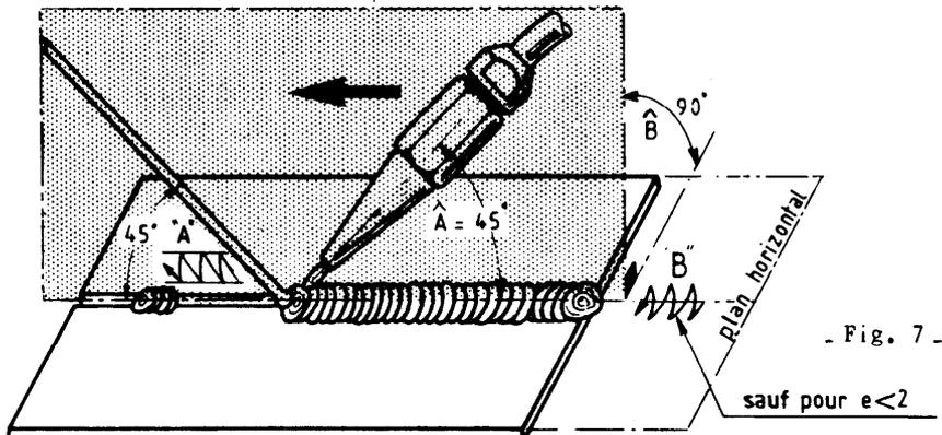
La fusion des bords et du métal d'apport doit être simultanée.
