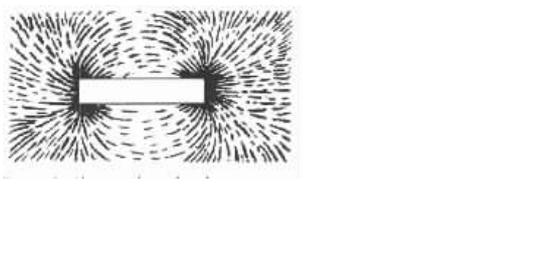
Le magnétisme est la propriété des métaux ferreux d'être attirés par les aimants. Seuls les métaux ferreux sont sensibles aux aimants Les métaux ne contenant pas de fer, comme le cuivre, l'aluminium et le laiton ne sont donc pas soumis aux effets du magnétisme.
