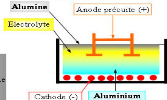
L'aluminium est obtenu grâce à une installation électrolytique (Voir le schéma ci-dessus). Il est élaboré à partir de l'alumine. Pour obtenir **une tonne d'aluminium**, il faut :
