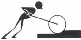
La malléabilité est la facilité avec laquelle un matériau se laisse façonner, étendre et aplatir en feuille mince sous un effort de compression. Les procédés de compression sont le forgeage (martèlement) et le laminage (rouleau compresseur). L'or, l'argent, le fer blanc et le plomb sont très malléables. La malléabilité croît avec l'augmentation de la température.
