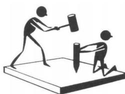
La dureté d'un matériau est définie comme la résistance qu'il oppose à la pénétration d'un corps plus dur que lui. Par exemple, l'acier est plus dur que l'aluminium, car il est plus difficile à rayer. En d'autres termes, la dureté dépend de la facilité avec laquelle un corps peut déformer ou détruire la surface d'un matériau en y pénétrant.
