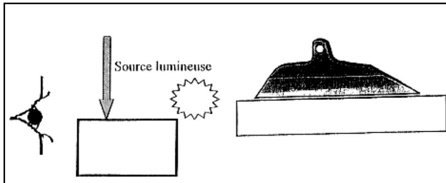
La planéité est correcte lorsque le réglet posé sur la surface à contrôler, laisse passer une raie de lumière uniforme sur toute la longueur de la portée.
