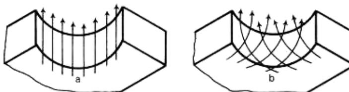
Tracer le rayon sur les deux faces. Utiliser une lime demi-ronde. Ébaucher le rayon par un limage en travers de la pièce. Contrôler la perpendicularité avec la face de la pièce. Pour la finition, le limage est exécuté en traits croisés (fig. b) ou en travers (fig. a) avec une lime demi-ronde (rayon de lime  $<$  au rayon à réaliser). Pendant la finition, contrôler souvent le rayon au calibre et la perpendicularité par rapport à la face.
