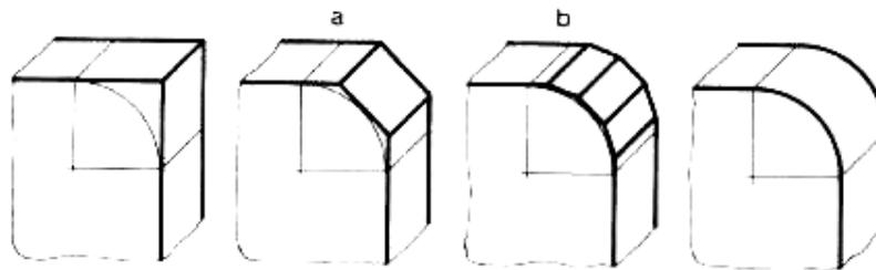
Après traçage du rayon sur les deux faces, exécuter un chanfrein à  $45^\circ$  tangent aux tracés (fig. a). Contrôler souvent la perpendicularité du chanfrein par rapport à la face. Exécuter d'autres pans tangents aux tracés à partir des angles du chanfrein (fig. b). Contrôler le rayon au calibre.
