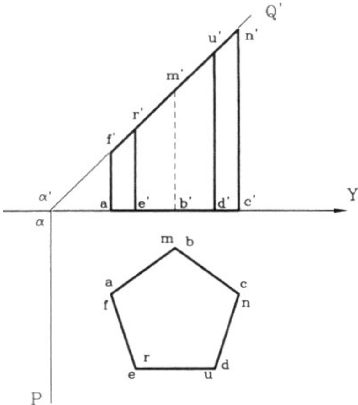
Un prisme droit à base pentagonale est coupé par un plan (P) « de bout » défini par ses traces ( $\alpha P$ ) et ( $\alpha' Q'$ ). On demande de rechercher la vraie grandeur de l'intersection du prisme et du plan (P).
