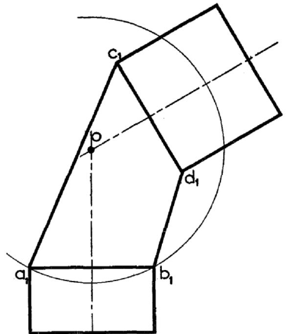
Fig. 16. — Le solide  $a_1b_1d_1c_1$  n'est pas un cylindre, sa projection n'est pas inscriptible dans un cercle,  $a_1c_1$  et  $b_1d_1$  ne sont pas parallèles.
