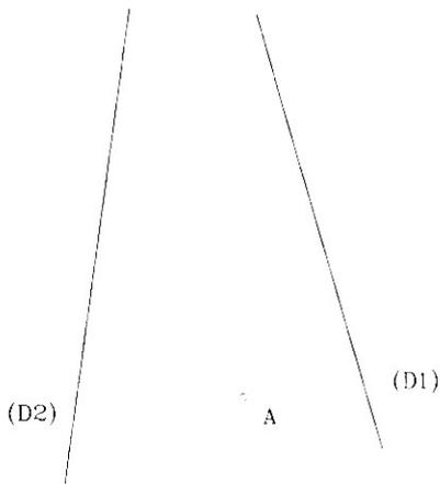
On demande de tracer une droite passant par le point A et l'intersection des droites (D1) et (D2) qui se situe hors des limites de l'épure.
