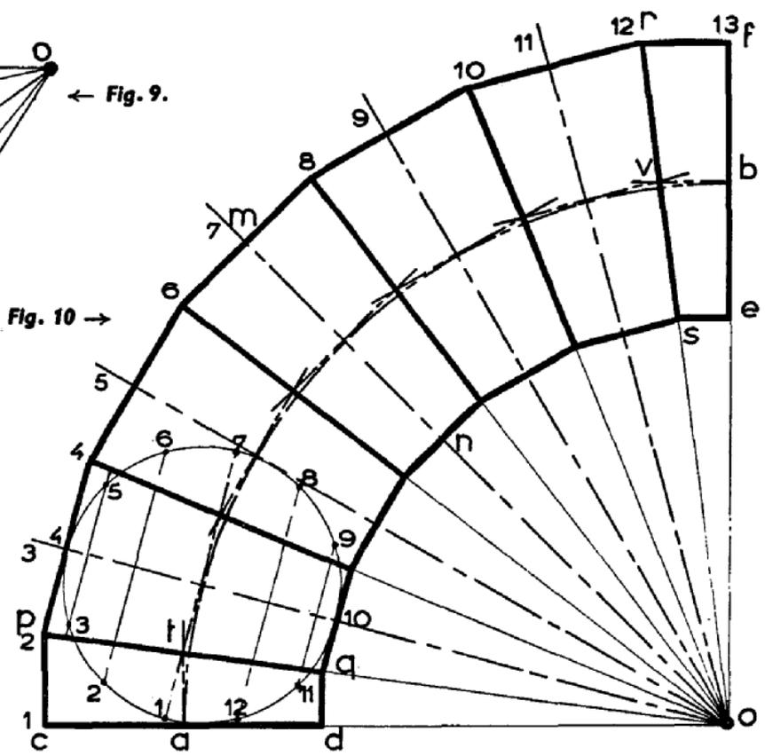
Fig. 12. — Les points représentent des coups de poinneau destinés à repérer les sections droites et les génératrices courtes, moyennes et longues.
