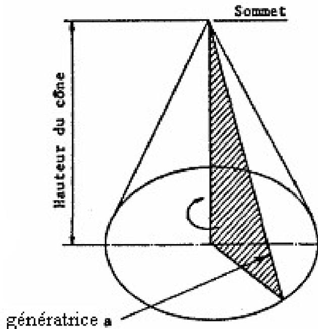
Le cône de révolution (ou cône droit) est un solide engendré par la rotation d'un triangle rectangle autour, de l'un des côtés de l'angle droit (fig. 1).
