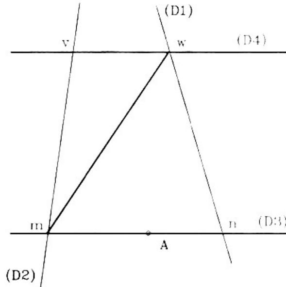
Le traceur dessine, à partir du point A, une parallèle à la droite (D1) qui coupe (MW) en I. De ce point, il trace ensuite une parallèle à (D2) qui coupe (VW) en B.
