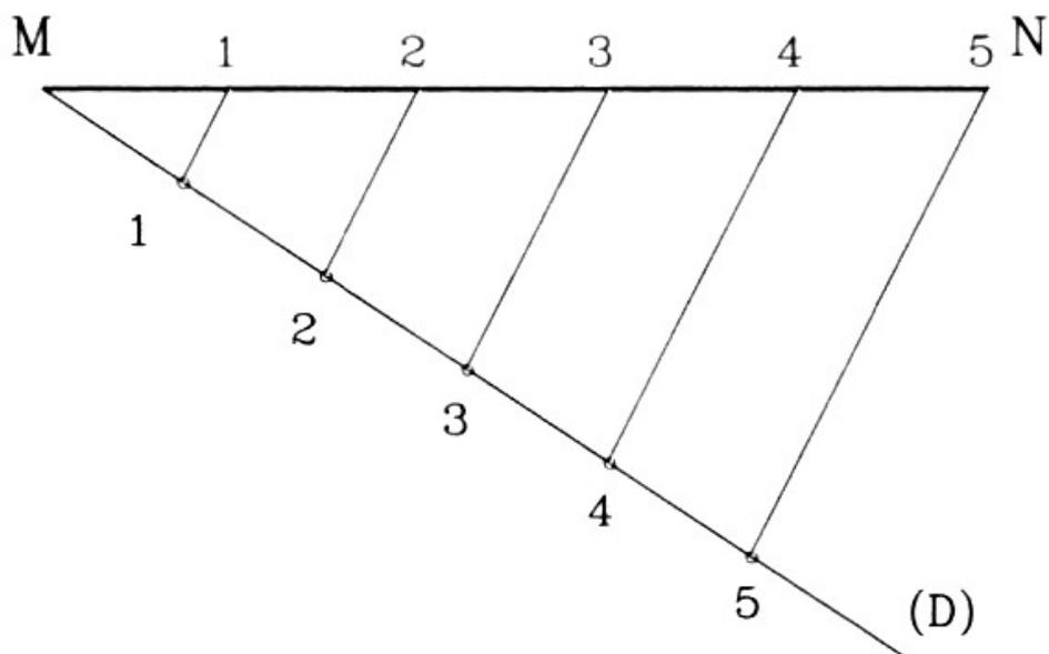
Pour diviser un segment de droite quelconque en parties égales, il est plus aisé d'utiliser la méthode des médiatrices. Lorsque cela n'est pas possible (division en 11, 13, 15, 17, etc. parties), il suffit de se rapprocher d'un multiple de 2.
