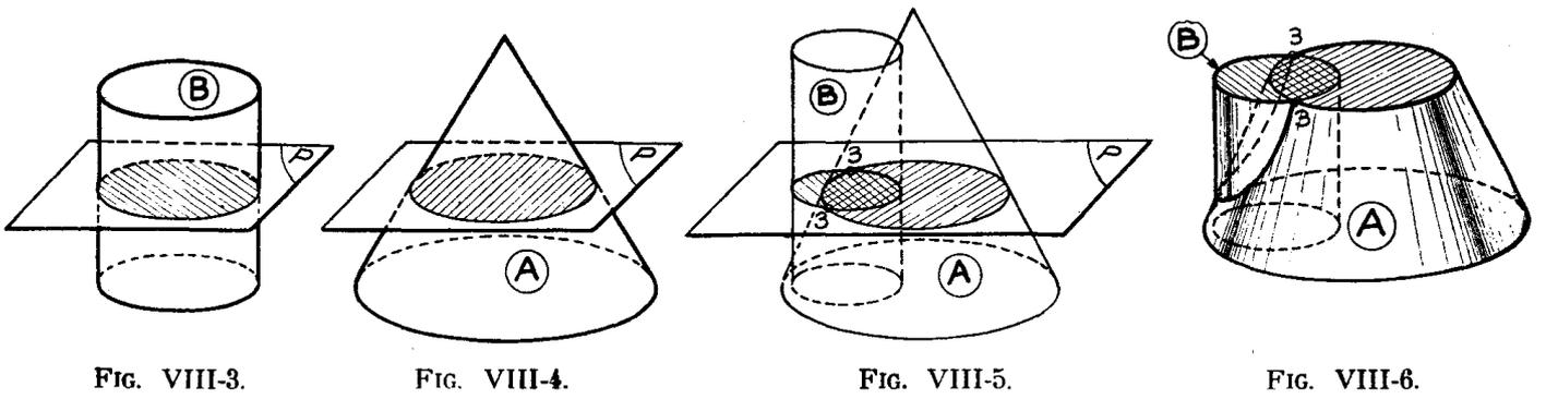
1° Les axes sont parallèles entre eux et perpendiculaires au plan horizontal.
