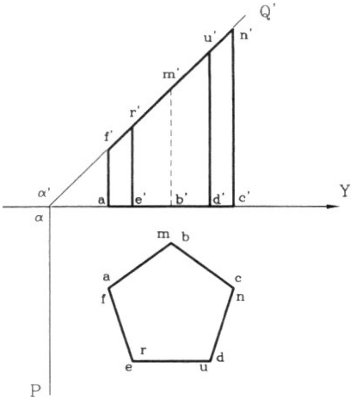
Un prisme droit à base pentagonale est coupé par un plan (P) « de bout » défini par ses traces ( $\alpha$  P) et ( $\alpha'$  Q'). On demande de rechercher la vraie grandeur de l'intersection du prisme et du plan (P).
