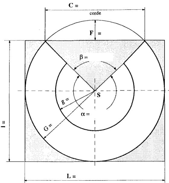
**DÉFINITION DU DÉVELOPPEMENT :** Dans ce cas l'angle au centre  $\alpha$  est > à  $180^\circ$
