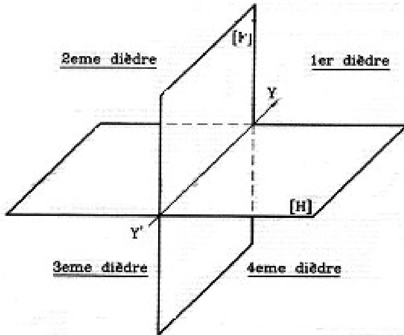
Comme les épures sont construites sur une surface plane, on suppose que le plan frontal est rabattu sur le plan horizontal. Cela donne la représentation suivante.
