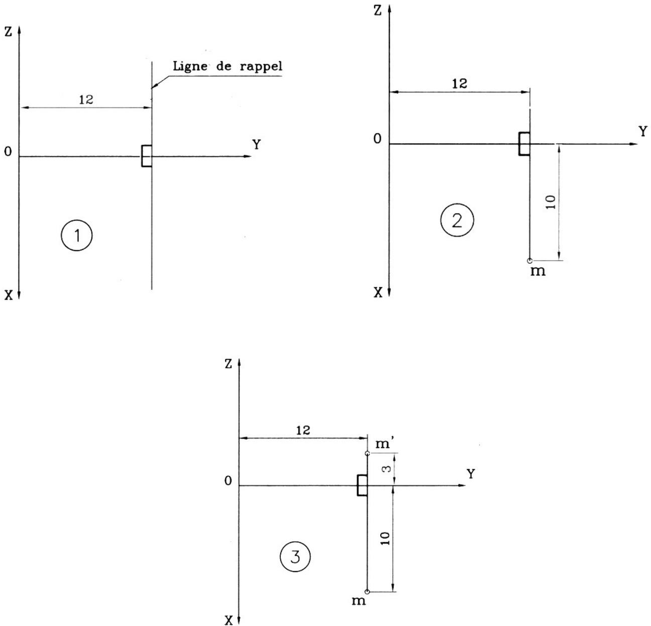
En **(1)** le traceur positionne sur le référentiel une ligne de rappel perpendiculaire à l'axe (OY) distante de 12 unités du point O.
