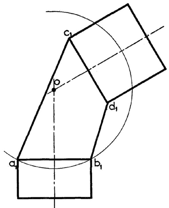
Fig. 16. — Le solide  $a_1b_1d_1c_1$  n'est pas un cylindre, sa projection n'est pas inscriptible dans un cercle,  $a_1c_1$  et  $b_1d_1$  ne sont pas parallèles.
