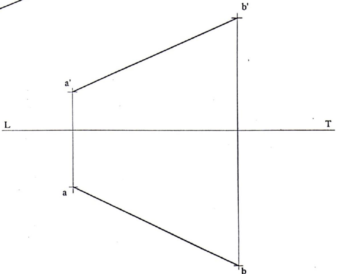
a) Rechercher la VG de la droite AB en utilisant un plan auxiliaire de bout positionné à 18 mm de AB
