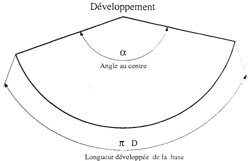
Pour tracer ou calculer le développement d'un tronc de cône de révolution, il faut connaître :
