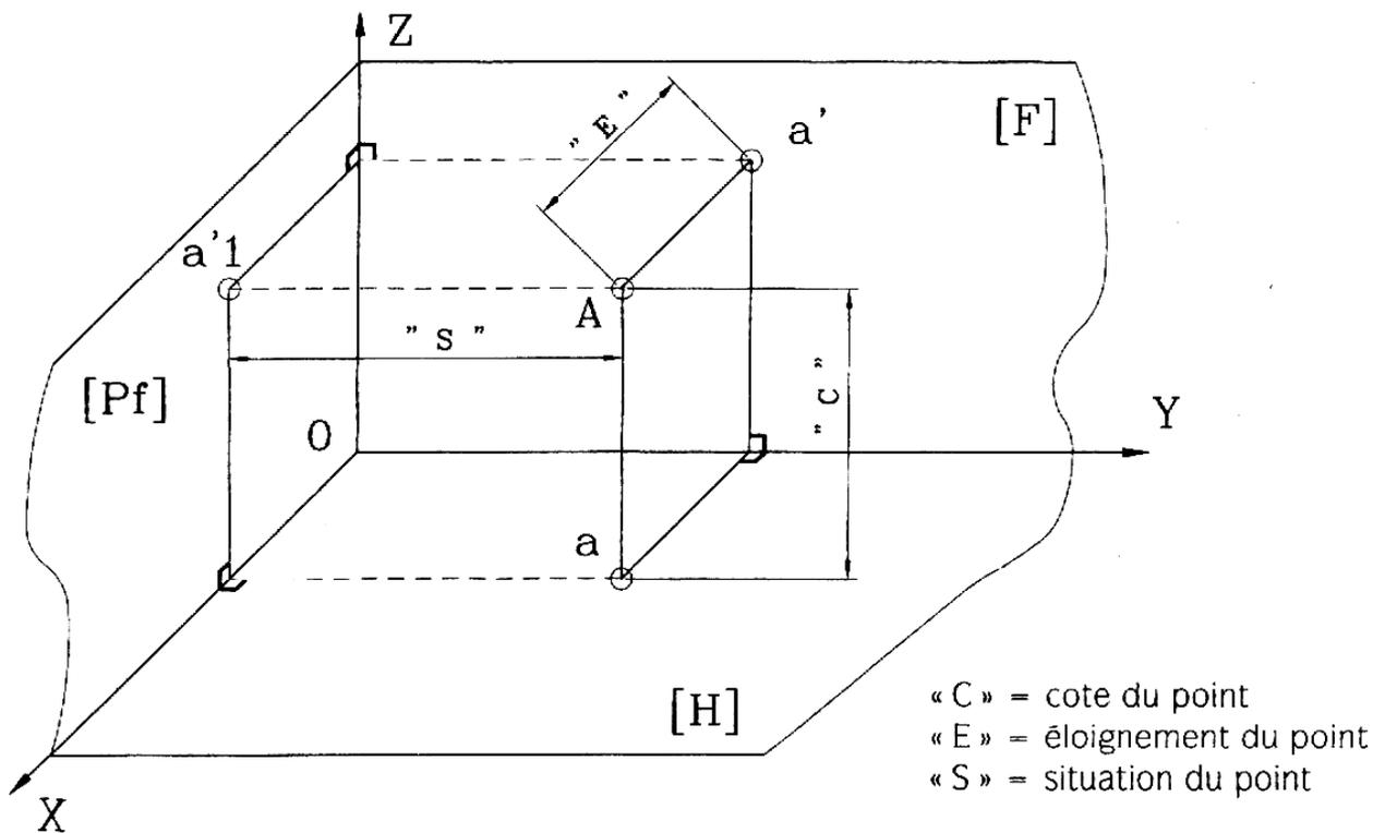
La « **COTE** » d'un point, distance qui sépare le point du plan horizontal [H], se lit dans le plan frontal [F] (Direction des Z) .
