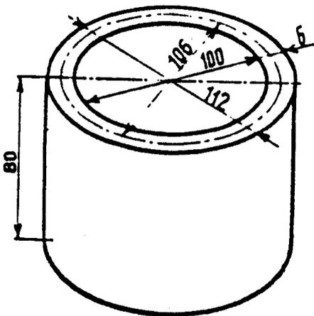
Déterminer les dimensions du développement du cylindre ci-contre :
