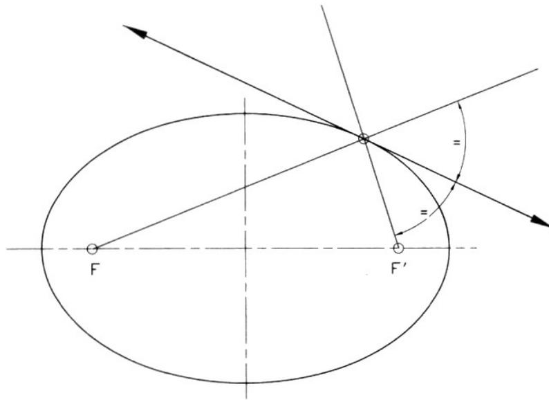
Le point est situé sur l'ellipse. La tangente extérieure à l'ellipse est la bissectrice extérieure de l'angle formé par les deux rayons focaux.
