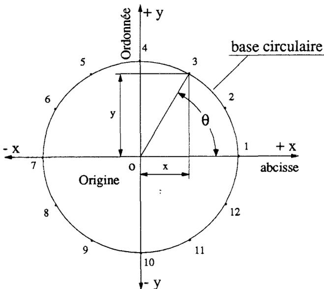
Pour les autres repères, on fait varier ceux-ci dans le sens trigonométrique, et pour se situer avec facilité, sur le centre de la base circulaire, l'on pose le centre du système d'axes (abscisse et ordonnée) qui nous déterminera chaque extrémité de génératrice par rapport à l'origine. Ce qui donne pour la position d'un point sur la base circulaire:
