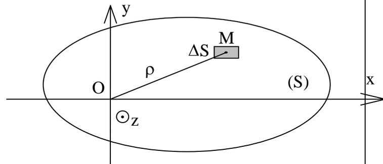
Le moment quadratique polaire élémentaire de  $\Delta S$  par rapport à (O,  $\vec{z}$ ) perpendiculaire en O au plan de la figure et noté  $\Delta I_O$  est défini par :
