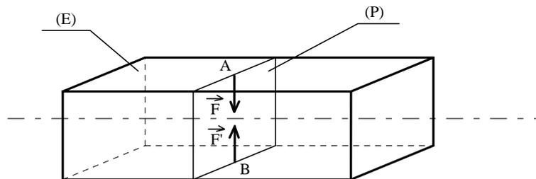
Sous l'action de ces deux forces la poutre tend à se séparer en deux tronçons E1 et E2 glissant l'un par rapport à l'autre dans le plan de section droite (P).
