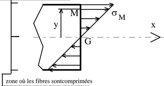
La contrainte normale  $s$  en un point M d'une section droite ( $s$ ) est proportionnelle à la distance  $y$  entre ce point et le plan moyen passant par G.
