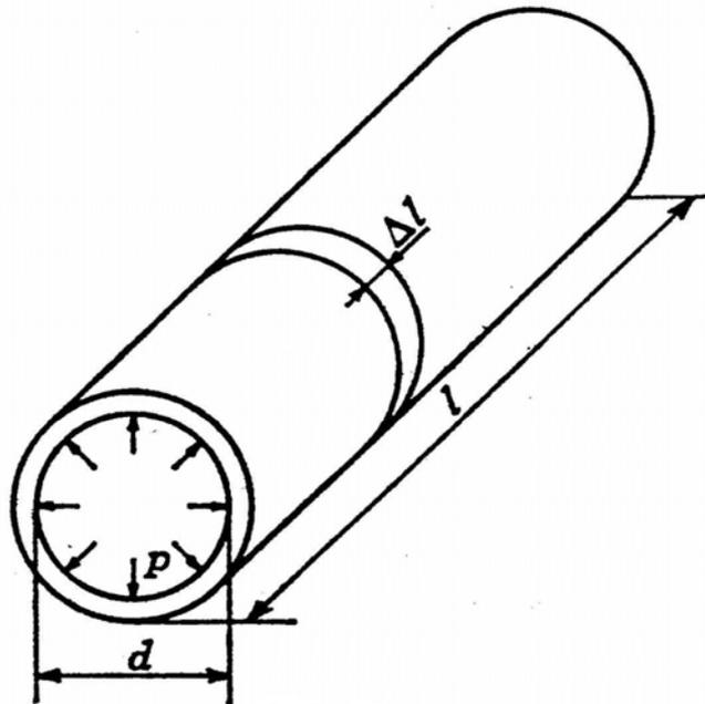
Soit un réservoir cylindrique clos (diamètre intérieur  $d$ , longueur  $l$ ) soumis à une pression intérieure  $p$
