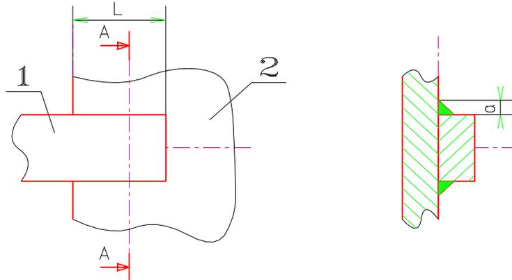
Sur cette barre s'exerce une force horizontale  $F = 1,5 \cdot 10^4 \text{ N}$ . Le métal d'apport utilisé pour la soudure a une contrainte pratique au cisaillement  $\tau_p = 200 \text{ MPa}$ . On adopte un coefficient de sécurité de 4.
