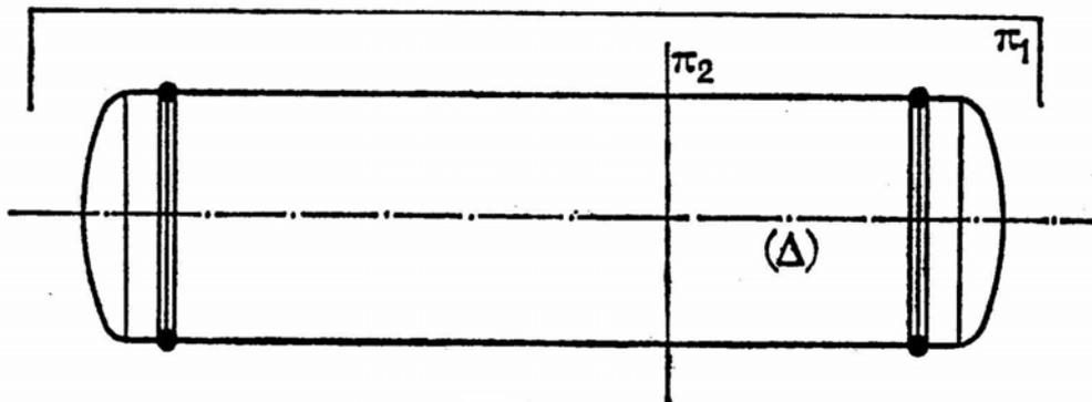
Pour déterminer les contraintes, effectuons une section et mettons en équilibre l'un des deux tronçons.
