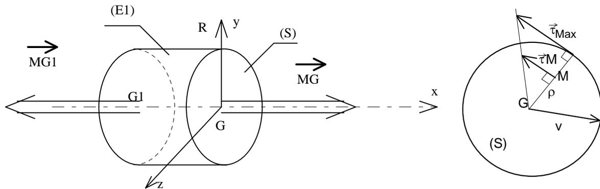
Soit M un point de la section droite (S) de la poutre situé à une distance  $\rho$  du centre G de la section (voir ci-dessus). On définit la contrainte de torsion  $\tau$  en M par la relation :
