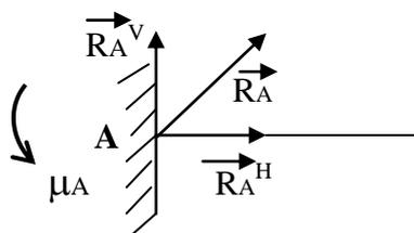
**V- Calcul des réactions d'appuis :**
