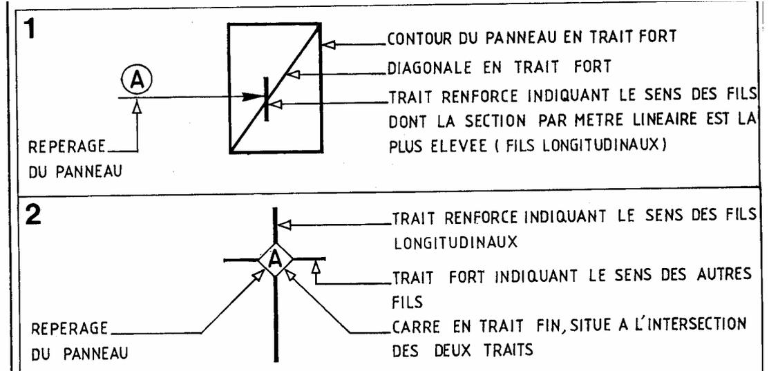
Dans l'exemple de la page précédente, où la représentation n°1 a été utilisée, les panneaux inférieurs et les panneaux supérieurs figurent sur le même dessin. On les différencie en représentant le contour des panneaux supérieurs en traits interrompus forts.
