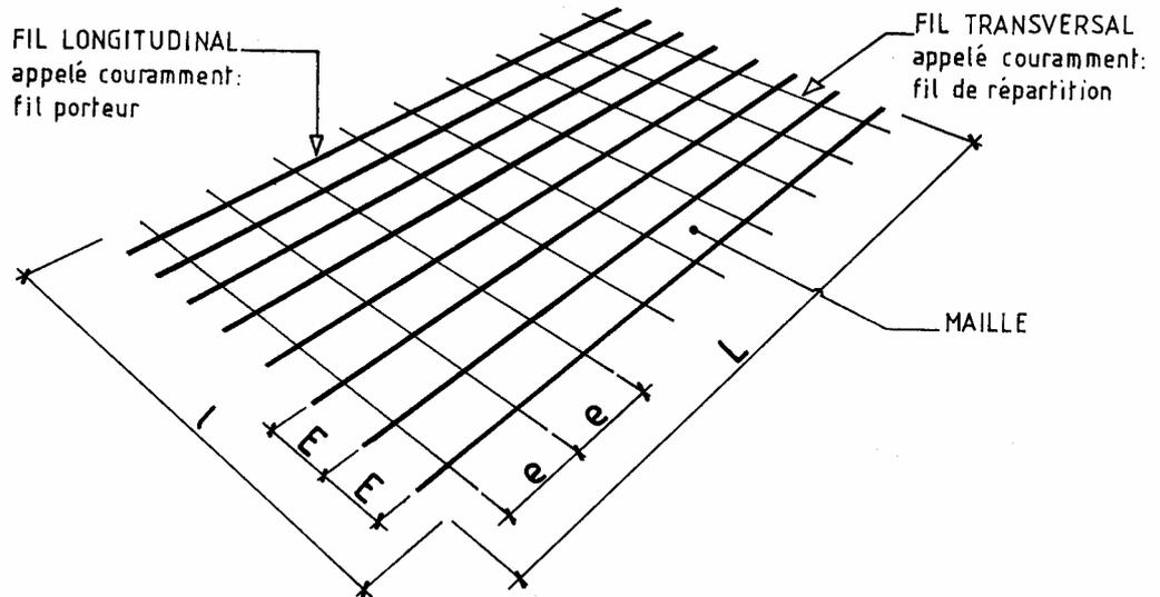
UN TREILLIS SOUDE EST CONSTITUE DE FILS D'ACIER ASSEMBLES ENTRE EUX PAR SOUDURES.
