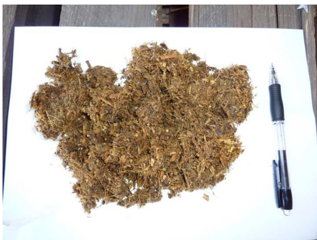
Figure 9, Photo de bois humide, après la percolation
