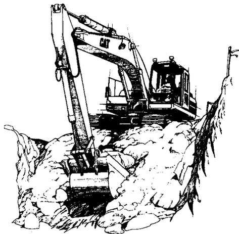
b) **pelle équipée en butte** – dans ce cas elle travaille devant un front de taille dont la hauteur ne doit pas dépasser la hauteur maximale d'élévation du godet, qui se remplit en raclant le front de taille de base en hauteur.
