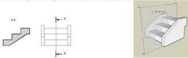
Ce type de section s'appelle section sortie puisqu'elle est dessinée à l'extérieur de la pièce.
