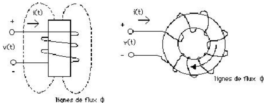
Dans les circuits électriques les bobines sont souvent représentées de la manière suivante :
