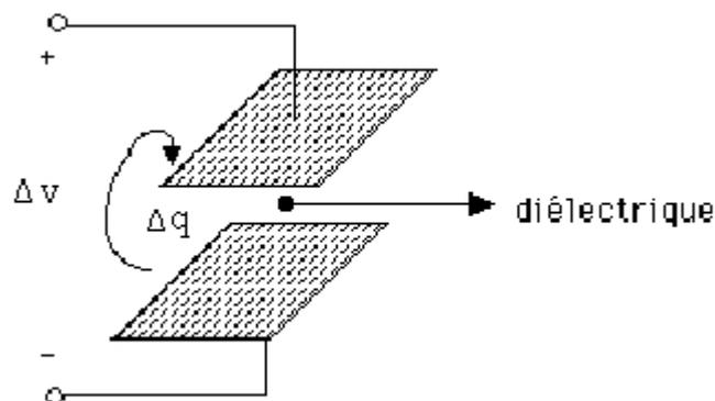
Sur les schémas électriques le condensateur est représenté de la manière suivante:
