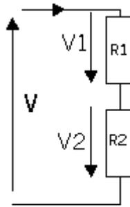
Si on veut connaître la tension appliquée à une résistance placée avec d'autres résistances en série il suffit d'appliquer la règle du pont diviseur en tension : cette tension est égale à la tension appliquée à toutes les résistances \* la valeur de la résistance / la résistance équivalente. Donc :
