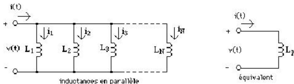
L'inverse de l'inductance équivalente à plusieurs bobines montées en parallèle est la somme des inverses de ces inductances :
