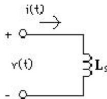
Le flux (unité : le weber) créé par une bobine est proportionnel au courant traversant cette dernière et répond à la loi suivante :
