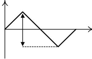
**Valeur moyenne :** de façon générale, la valeur moyenne se calcule en divisant l'aire sous la courbe par la durée d'un cycle de l'onde.
