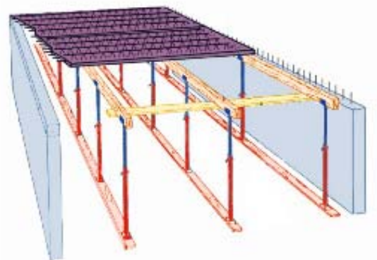
Pose de dalles alvéolaires
