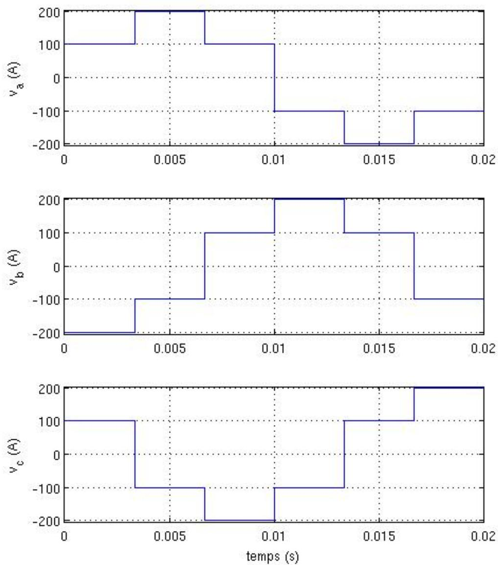
FIG. 1 – Onduleur triphasé : tensions simples
