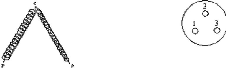
Pour effectuer le repérage de ces trois bornes il faut mesurer à l'aide d'un ohmmètre la résistance entre chaque point. La résistance la plus faible correspond à l'enroulement permanent, la résistance intermédiaire correspond à l'auxiliaire et la résistance la plus élevée doit être la somme des deux autres.
