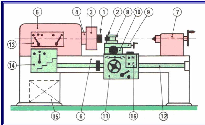
**Figure 2. Tour parallèle Schéma.** (1) Pièce ; (2) Outil ; (3) Mandrin ; (4) Broche ; (5) Poupée fixe ; (6) Banc ; (7) Poupée mobile ; (8) Tourelle porte-outils ; (9) Chariot supérieur ; (10) Chariot transversal ; (11) Traînard ; (12) Barre de chariotage ; (13) Boîte des vitesses ; (14) Boîte des avances ; (15) Moteur ; (16) Contacteur.
