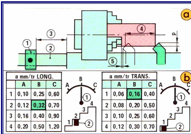
**Avance automatique du chariot transversal :  $a \text{ mm/tr}$**
