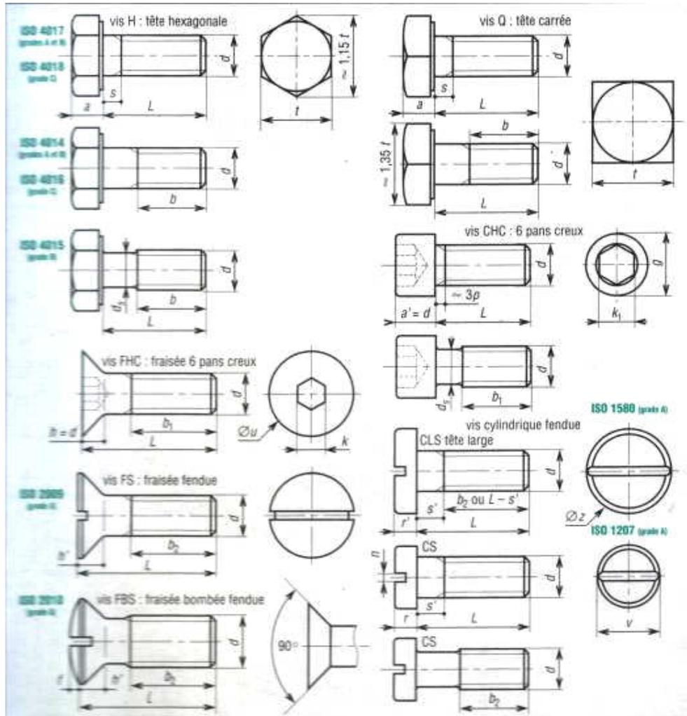
**Exemples de désignation :** vis à tête hexagonale ISO 4014-M12x80-4.6 (vis H partiellement filetée,  $d = 12$ ,  $L = 80$ , classe 4.6) ;
