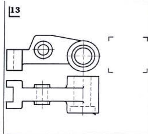
Pour l'objet proposé en perspective, dessiner la vue de face repérée par une flèche, plus deux vues au choix : vue de dessus et vue de gauche (ou de droite). Dessiner les parties cachées. Les dimensions sont repérées par des intervalles de 10mm ( $u=10$ ), les trous sont débouchants.
