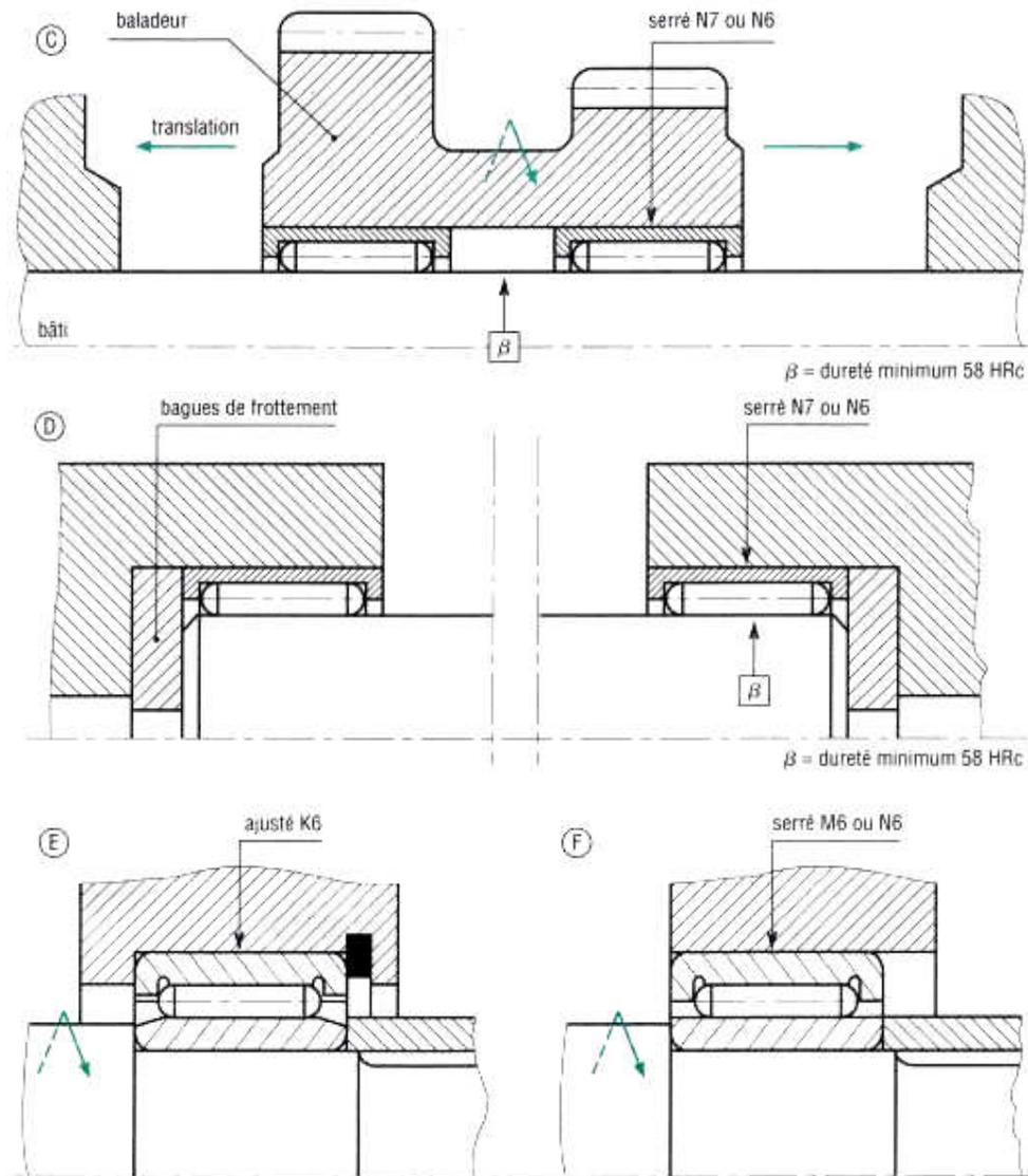
Les liaisons réalisées à partir de ces seuls roulements ne supportent pas les charges axiales. Celles-ci doivent donc être supportées par un autre dispositif.
