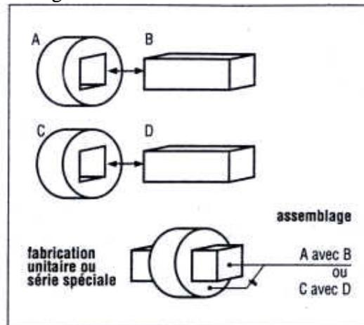
**Pièces appariées, ou appairées :** Les pièces sont non interchangeable et doivent être impérativement monter ensemble, par paire. Les dimensions de l'une sont exécuter < sur mesure > à partir des dimensions de l'autre ou choisies < statistiquement >.
