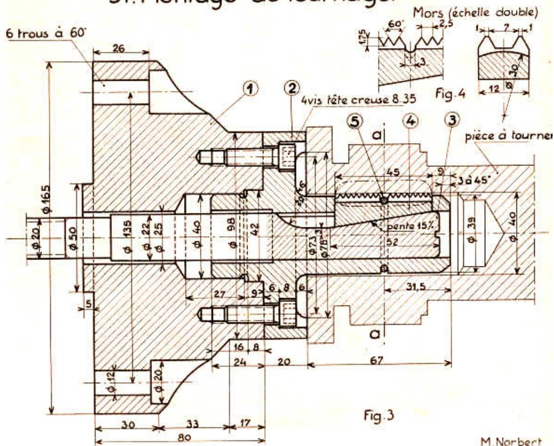
**Travail demandé :** dessin d'exécution des pièces détachées. Echelle 1. Format A3. V.
