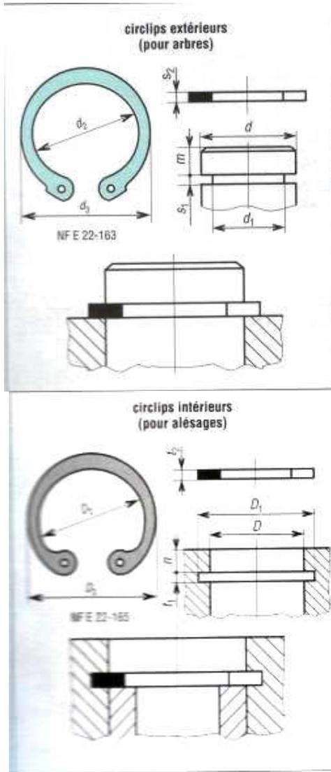
Circlips extérieurs : principales dimensions normalisées
