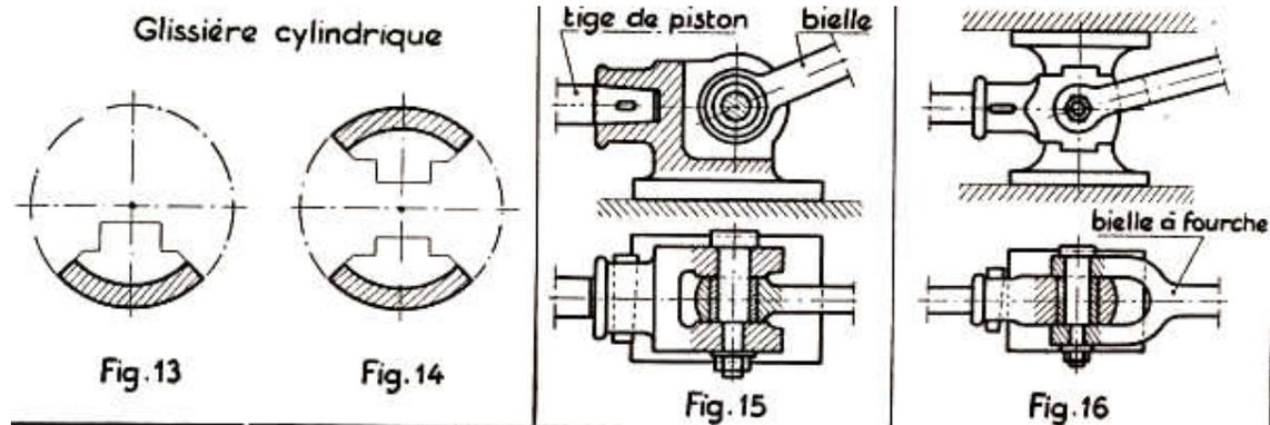
**2. Coulisseau ou crosse.** Cet organe doit permettre : la fixation de la tige de piston ; l'articulation de la bielle, la fixation des patins de guidage. La tige de piston est assemblée par emmanchement cylindrique ou conique, avec clavetage transversal .
