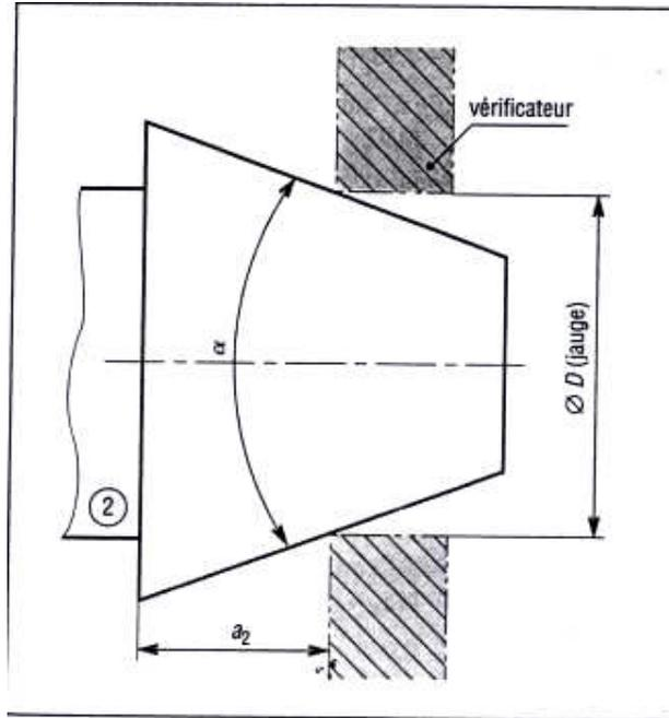
C'est en fait le vérificateur qui est coté, la mention « jauge » permet au services des méthodes de la réaliser à partir des tolérances habituelles des gabarits et d'en déduire les incertitudes de mesure. Une telle cotation ne définit que des dimensions locales : la définition complète du cône doit se faire, comme l'indique figure 10.
