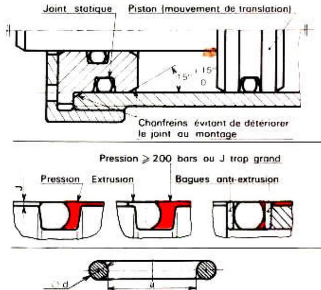
Le jeu J ( Fig. ci-contre ) doit être d'autant plus réduit que la pression est plus élevée. On admet généralement un jeu maximale correspondant à celui d'un ajustement :
