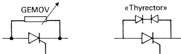
Figure 3.4-5 Protection des SCR contre les surtensions
