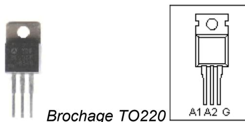
Figure 3.5-4 Exemple d'un boîtier de triac
