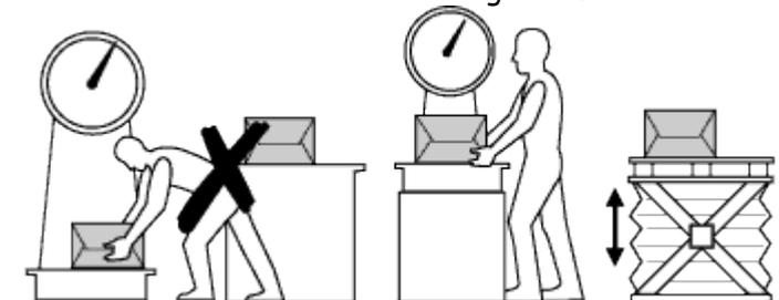
La plate-forme automatiquement réglable s'ajustera à la taille du travailleur.
