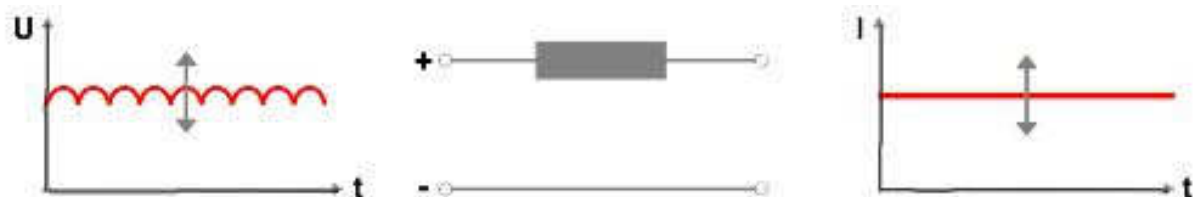
Circuit intermédiaire à courant continu variable.
