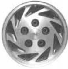
Les alliages d'aluminium-silicium sont très faciles à couper, ce qui permet de réaliser des formes complexes et des pièces à parois minces. On les trouve surtout dans l'industrie automobile: corps de carburateurs, pistons de moteurs, blocs-cylindres, etc. De plus en plus de pièces sont coulées à partir d'alliages d'aluminium en raison de la légèreté de ce métal.
