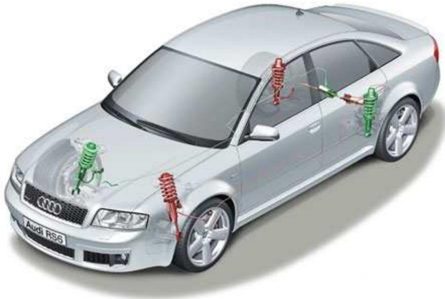
Les amortisseurs sont reliés entre eux hydrauliquement en diagonal par l'intermédiaire d'une valve (l'amortisseur avant droit lié avec celui de l'arrière gauche, et réciproquement).
