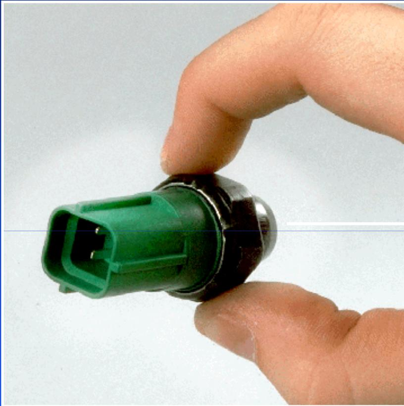
**Il se trouve sur la ligne haute pression entre le condenseur et le détendeur.**
