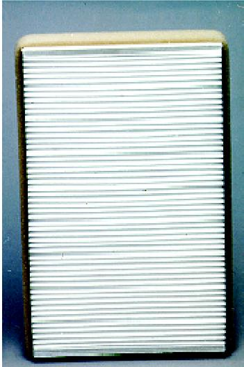
Il se situe **en entrée d'air** dans le compartiment moteur ou **entre le pulseur et l'évaporateur** sous la planche de bord.
