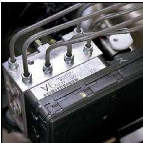
**Boîtier électro-hydraulique ABS Toyota**
