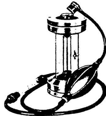
*Nota : le tuyau de prélèvement est muni d'un filtre permettant de piéger la vapeur d'eau contenue dans les gaz brûlés (**Etude de la combustion page 21**).*
