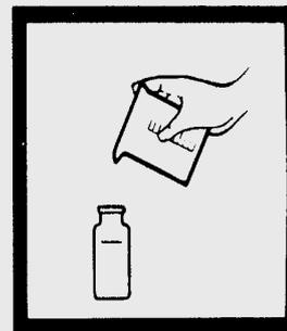
4. Remplir un flacon colorimétrique avec 25 ml d'échantillon.
