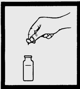
5. Ajouter le contenu d'une gélule de réactif PhosVer 3 au flacon (l'échantillon préparé). Agiter pour mélanger.
