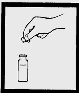
5. Ajouter le contenu d'une gélule de réactif SulfaVer 4 au flacon (l'échantillon préparé). Agiter pour mélanger.
