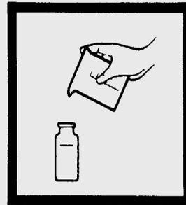
4. Remplir un flacon colorimétrique avec 25 ml d'échantillon.
