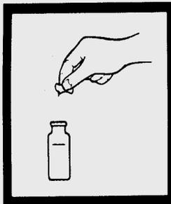
5. Ajouter le contenu d'une gélule de solution de FerroZine au flacon (l'échantillon préparé). Agiter pour mélanger.
