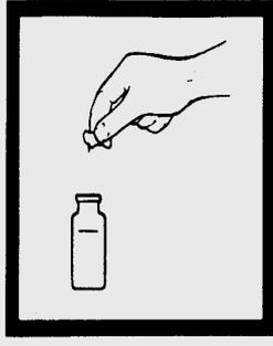
11. Lorsque le minuteur sonne, ajouter le contenu d'une gélule d'acide citrique au flacon (l'échantillon préparé). Agiter pour mélanger.
