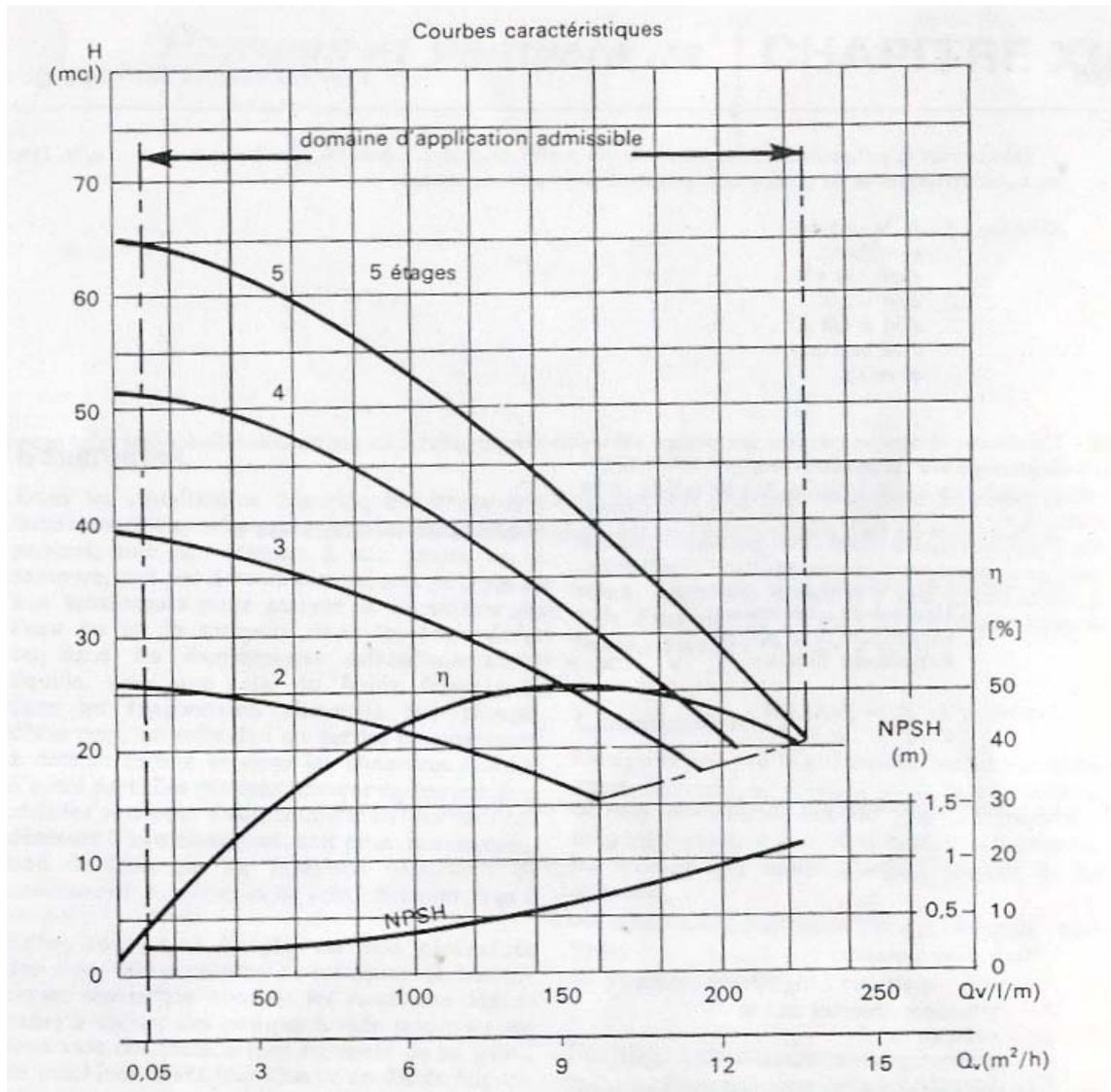
5 - Les caractéristiques  $H_T = f(q_v)$  et  $\eta = f(q_v)$  d'une pompe centrifuge, à vitesse constante  $N = 1\,470$  tours/min sont données par le tableau suivant :
