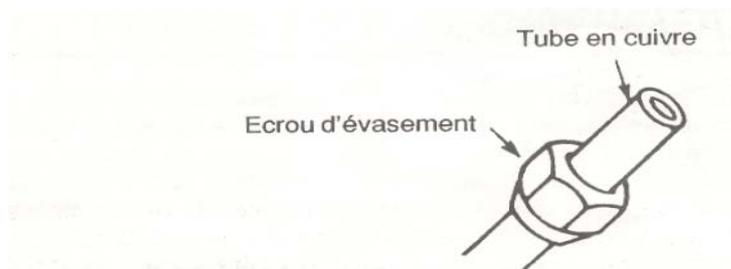
Figure 8 : installer l'écrou avant commencer le dudgeon
