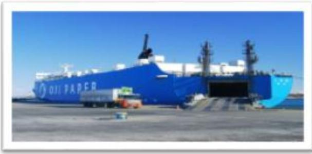
**Navire Ro-Ro** Navire de charge muni d'une passerelle permettant une manutention horizontale par roulage ou navire roulier (Roll-on, Roll-off).
