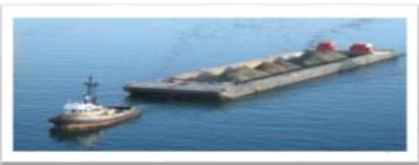
**Remorqueur** Navire qui aide les manœuvres d'entrée et de sortie des navires dans le port. Remorquage portuaire pour aider les navires à s'accoster et appareiller, déplacement de barges et pontons. Remorquage en mer pour déplacer des grues, navires sans propulsion, ou assistance à des navires en détresse.
